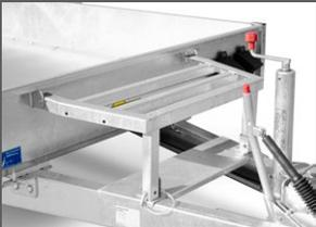
Baggerschaufelablage klappbar für V-Deichsel
